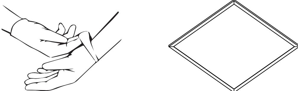
**Vid installation av LED-armaturen skall det vara rent i rummet och handskar skall användas!**
